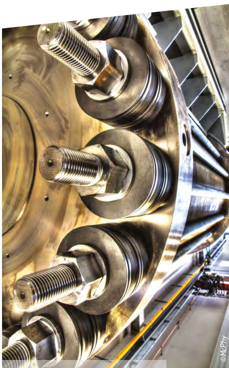
Elektrolyseur des Herstellers McPhy. Électrolyseur du fabricant McPhy.
